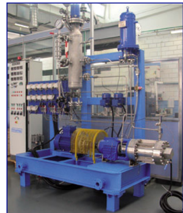
Fluiten seal Fluiten test bed
